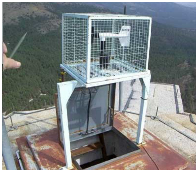
Veleta-anemómetro, tipo “propellor”, protegida por una jaula de Faraday, instalada en su día en lo más alto de la Cruz, para el estudio y seguimiento de su flexión por impacto eólico.
