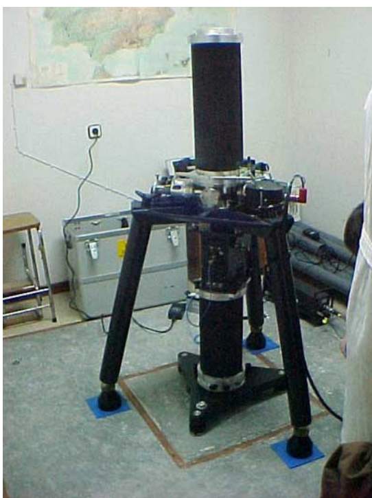
Aparato de observación gravimétricas (gravímetro absoluto) de las citadas instalaciones.
